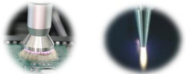
图 8：50 毫米旋转喷嘴 (左) 和 6mm 尖喷嘴 (右)
